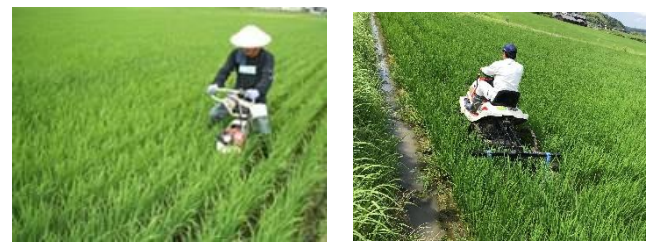
乗用型、田植え機装着型の溝切り機
